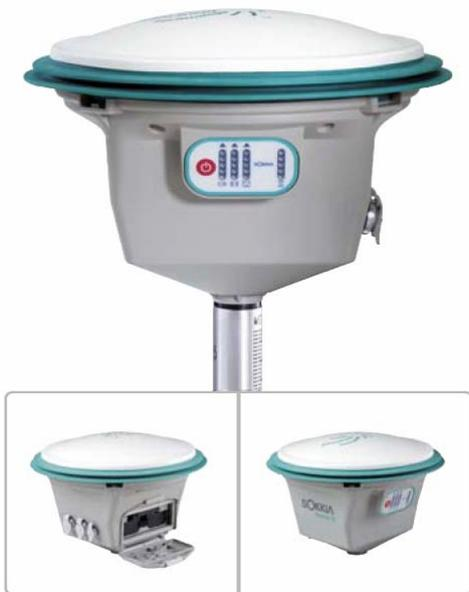
O Radian IS da **SOKKIA** é um receptor integrado, dupla frequência. Este receptor pode executar trabalhos pós-processados e RTK (Tempo Real). O sistema integrado, receptor, antena, memória e baterias não utilizam cabos. O Radian IS utiliza somente um cabo para a coletora de dados. Essas características combinadas com as tecnologias PAC e Pinwhell (inclinação da antena se transforma em choke-ring, eliminando os multicaminhamentos), permite um excelente rastreo com altíssima qualidade.
